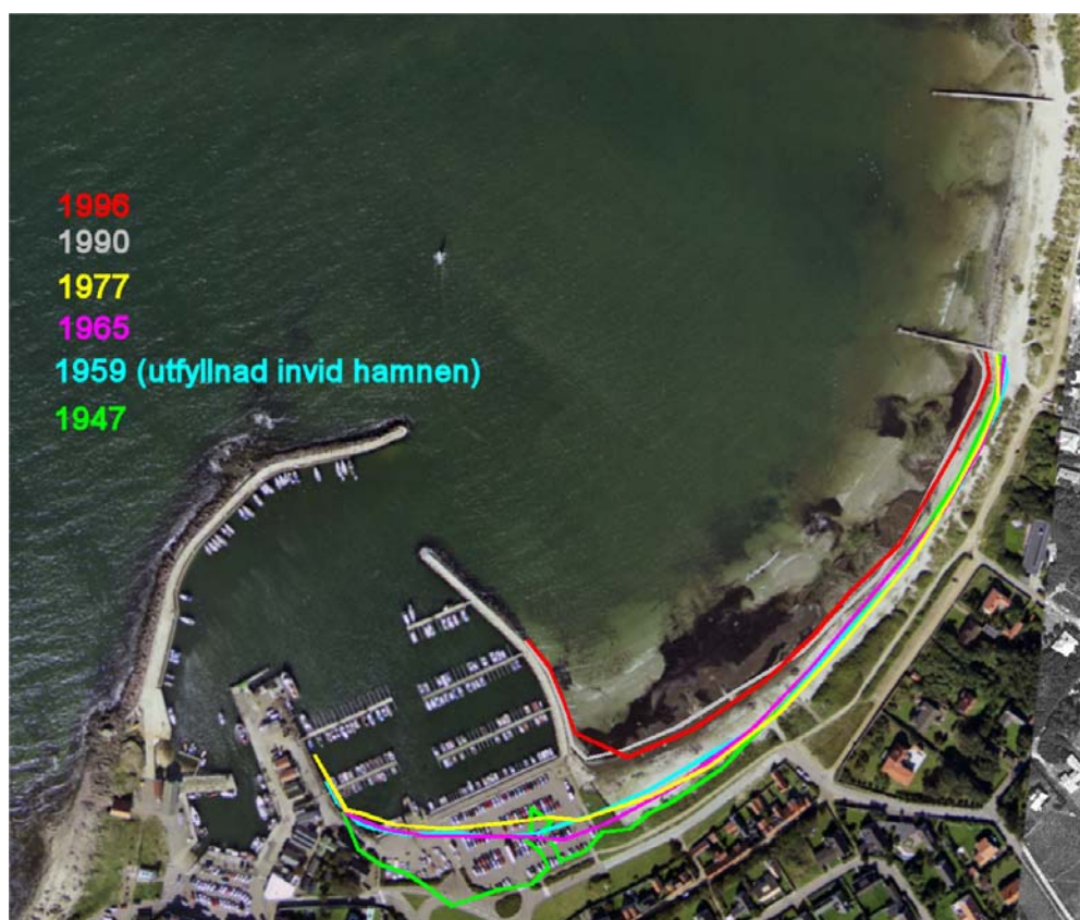
Figur 8 Sammanställning av strandlinjer från flygbilderna 1947 till 1996, bakgrunden är flygbilden från 1990. Notera att strandlinjen från 1990 är osäker då det låg stora mängder tång på stranden vid fototillfället.
